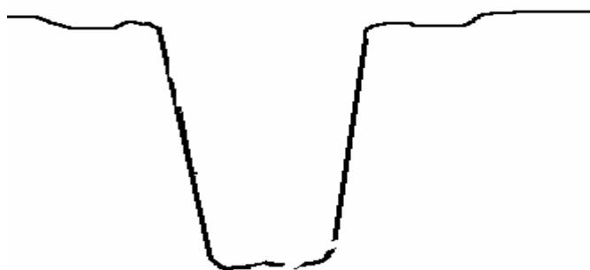
Рис.2. АЧХ фильтра на щелевых линиях
